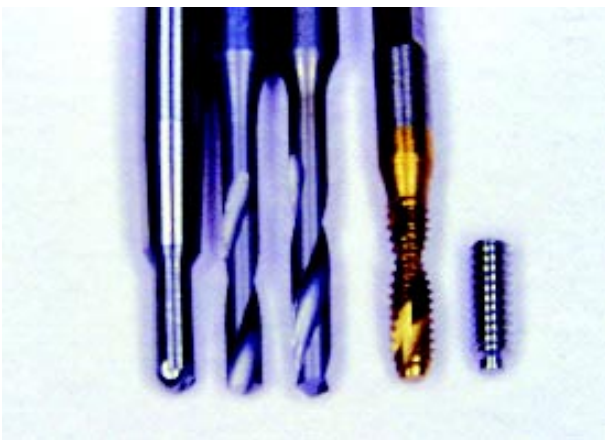
FIGURA 2 – Brocas para perfuração; macho de tarracha e parafuso do Kit.
