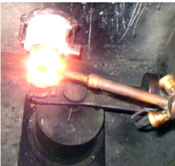
Figura 2: Fundição do metal com maçarico.
