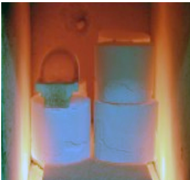
Figura 1: Cadinho e conjunto modelo de revestimento – enceramento – cobertura de revestimento levados ao forno eliminação do padrão de cera e obtenção do molde para fundição.
