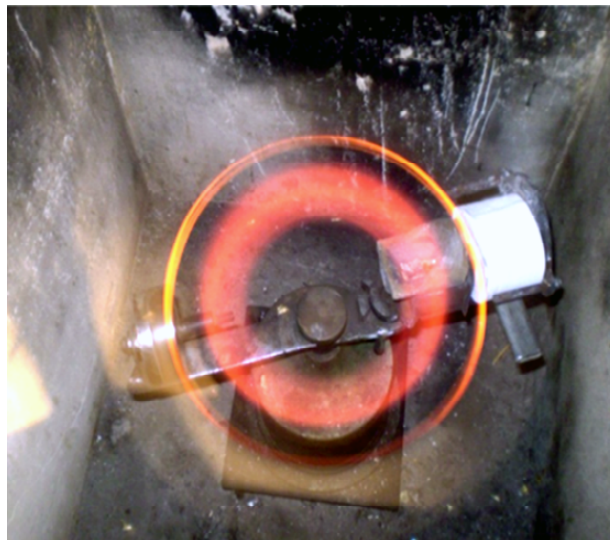
Figura 3: Injeção do metal no molde de revestimento por força centrífuga.
