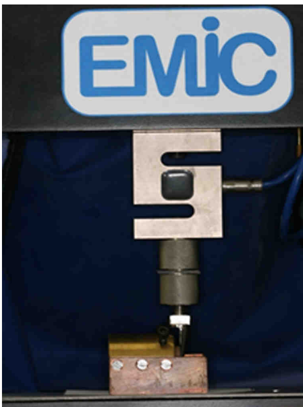
Figura 3-Dispositivo para apreens+úo do corpo-de-prova na EMIC
